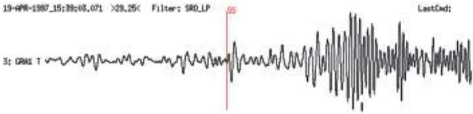
Рис. 4. Типичная сейсмограмма; землетрясение вблизи острова Северная земля, произошедшее 19 апреля 1997 [11]; красной линией отмечено начало прихода S-волн.
